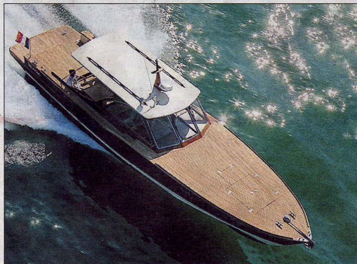
Pont en teck, coque en bois recouverte d'époxy, motorisation puissante, le picnic cabine est le dernier-né du chantier Dubourdieu.
